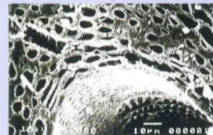
活性炭の細孔の顕微鏡写真 (比較例)
